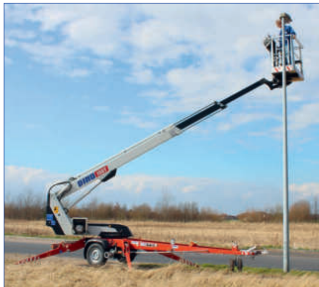
Autarker Betrieb mit Hatz-Dieselmotor
