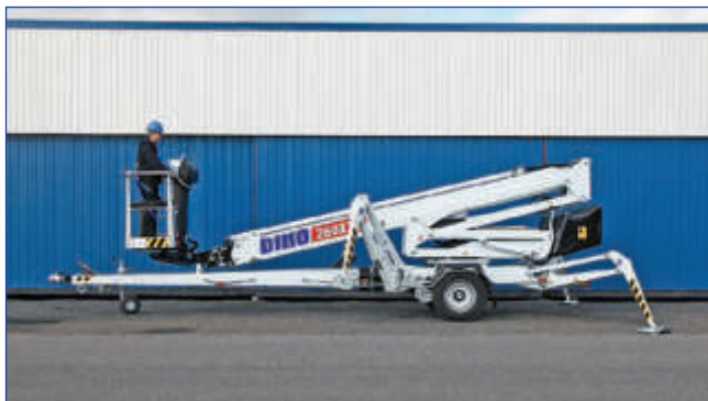
Abstützen/Verfahren und Nivellieren aus dem Korb
