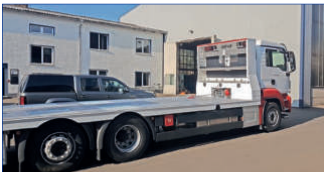
Plateaufbau aus Aluminiumprofilen zur Gewichtsreduzierung
